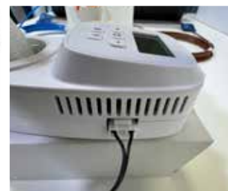
Den externen Bodenfühler am Thermostat anschließen.
